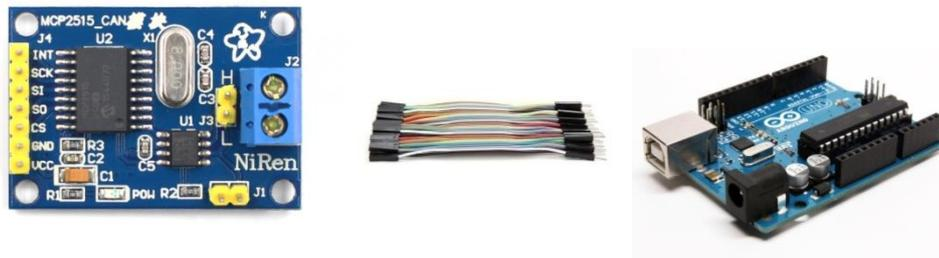
**Figure 4.3.** Matériel utilisé pour faire communiquer deux Arduino via le bus CAN
