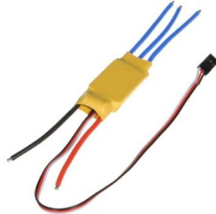
Figure 10. Driver ESC pour commander un moteur Brushless
